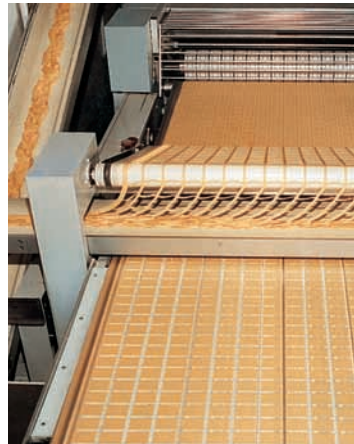
4 Découpeuse RTA à haute performance avec dispositif rotatif de gaufrage, de découpage et de séparation de la grille de pâte de retour.
