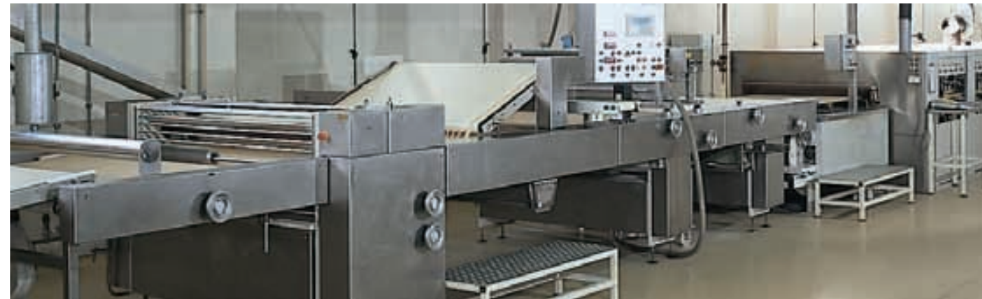
3 La pâte pour les biscuits secs est abaissée avec ménagement par un lamineur vers des cylindres réglables pour l'obtention de la bonne épaisseur avant son découpage.
